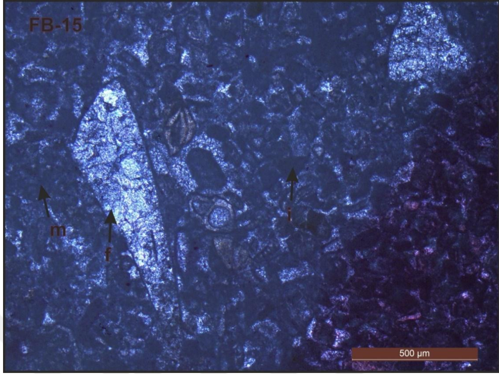
Şekil 5.3. Mikritle tutturulmuş bol miktarda fosil taneleri, kavkı parçaları, intraklast taneli kireçtaşı kesiti (Kayaç adı: İstiftaşı; İnce kesit alizerin red-s ile boyanmıştır, N: FB-15; Büyütme 4x, görünüm tek nikol; f: fosil, m: mikrit, i: intraklast).
