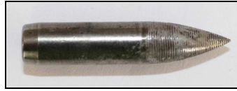
Şekil 6.10. DM09D numunesine atılan mermi çekirdeği.
