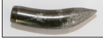
Şekil 6.15. YM15D numunesine çarpan merminin çekirdeğinin görünümü.
