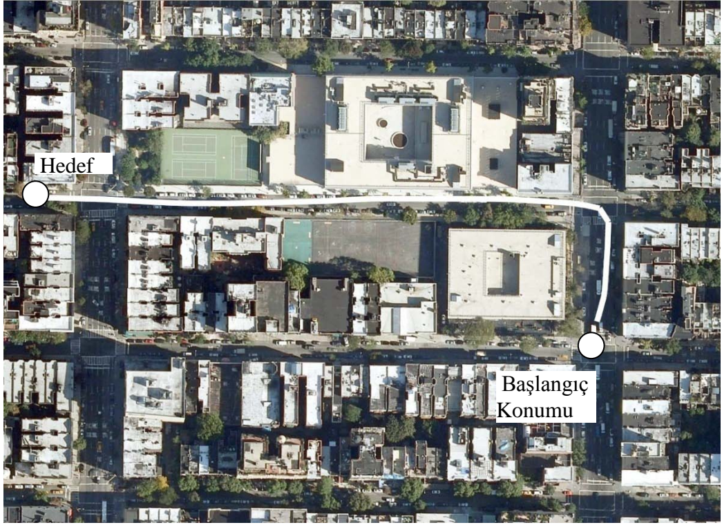
Şekil 6.25. Dördüncü hedefe ulaşana kadar dönerkanatın izlediği yol ( T_L = 1.5 )
