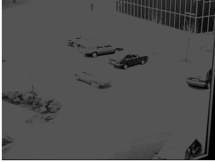
Şekil 2.11. Medyan fark yönteminde oluşturulan arka plan görüntüsü
