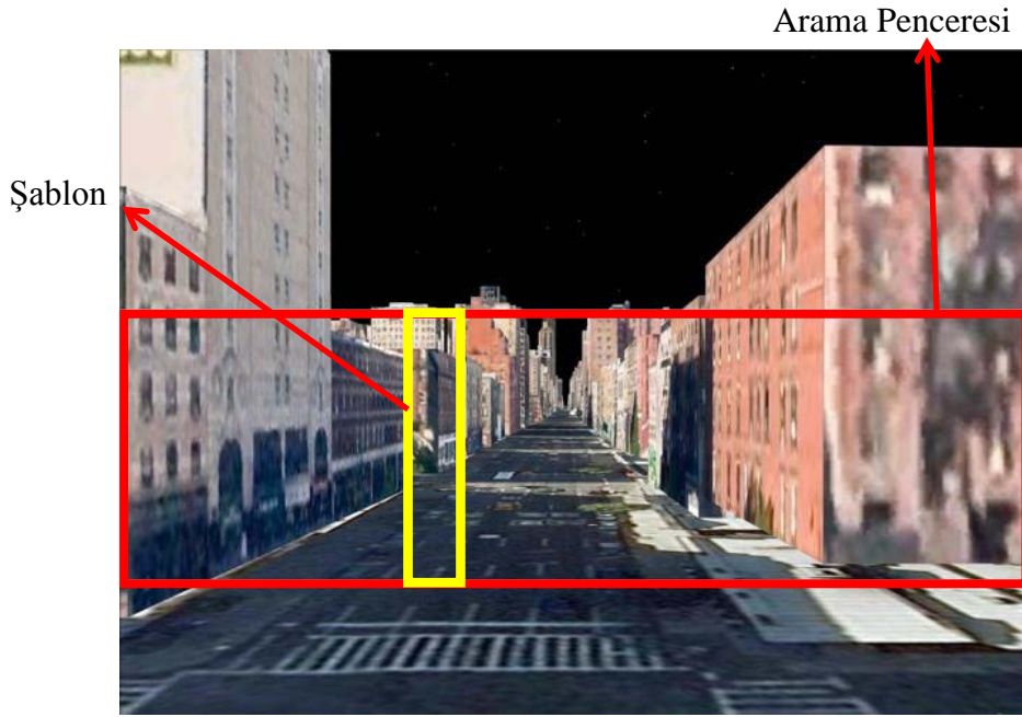
Şekil 6.17. Engellerden sakınma işleminde kullanılan arama penceresi ve şablon
