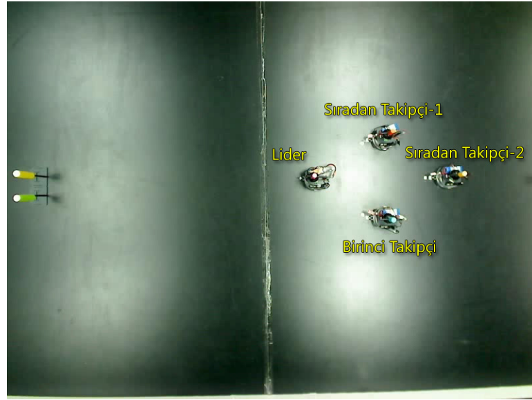
Şekil 4.9.: 4'lü Robot Dizilimi Tepe Kamerası
