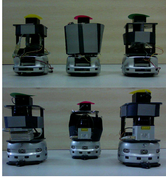
Şekil 5.2. Robotların geri-yansıtıcı barkodları
