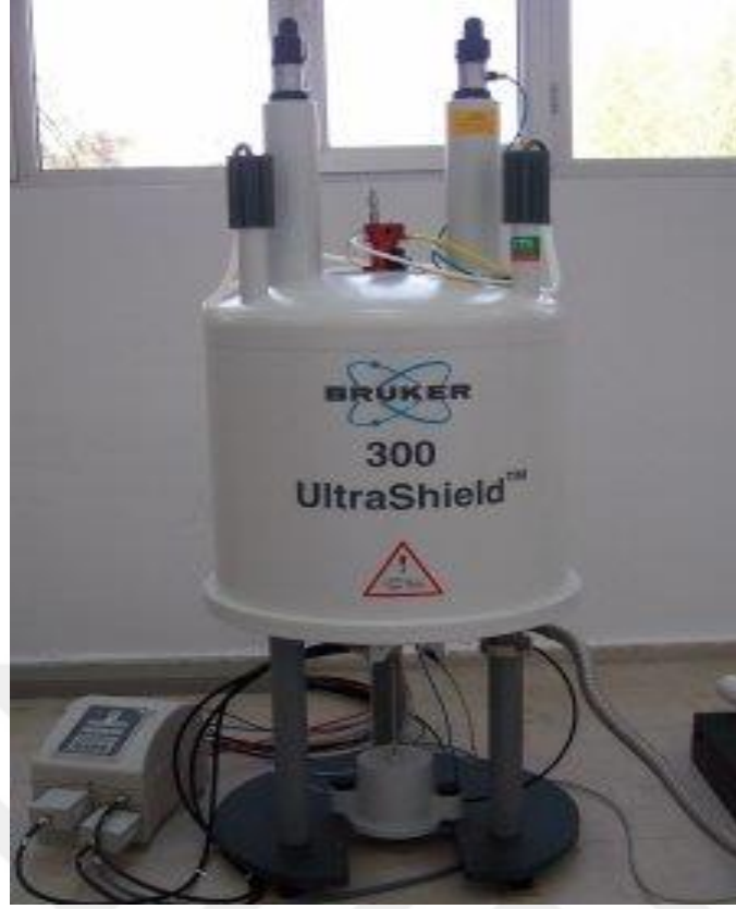
Şekil 3.4: Bruker Biospin Miknatis (Yüksek performanslı aktif siperli Ultrashield™ 300 MHz süper iletken miknatis)
