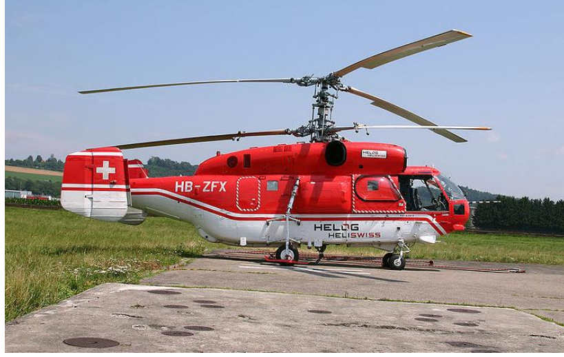
Şekil 1.14. Çift rotorlu koaksiyel düzenleşim, [9-10]
