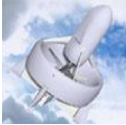
Şekil 1.12. Tek rotorlu yapıya sahip DKİ hava aracı, [10]
