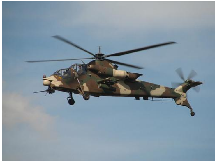
řekil 1.11. Tek ana rotor ve kuyruk rotorlu DKİ hava aracı, [11]
