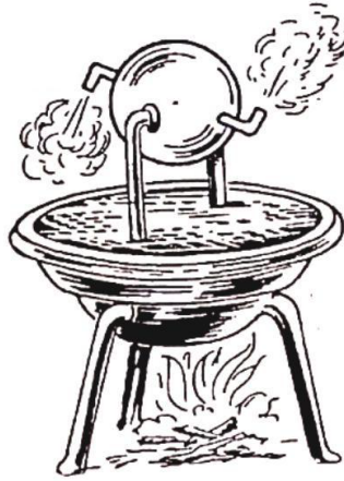
Şekil 1.1. Hero'nun tasarladığı ilkel jet motoru, Aeolipile [1]
