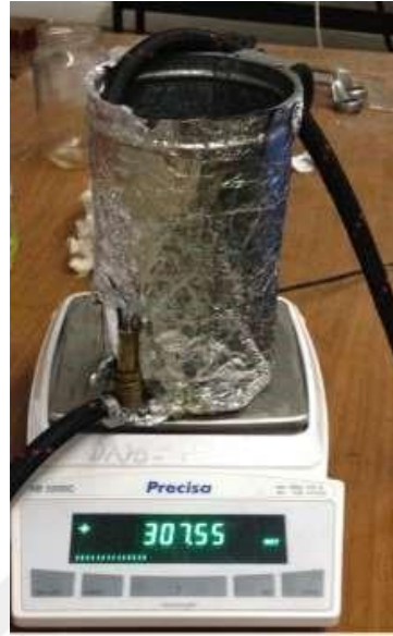
Şekil 5.5. Yakıt tüketimi hesaplamada kullanılan elektronik hassas terazi
