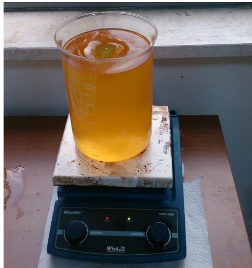
Şekil 5.7. Aspir yağının metil alkol ile karıştırılması
