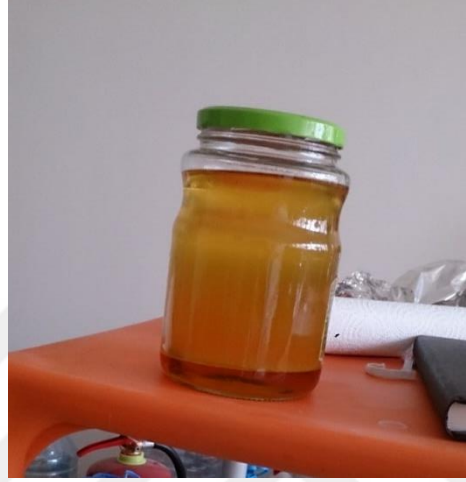
Şekil 5.8. Aspir yağındaki gliserolün çökmesi
