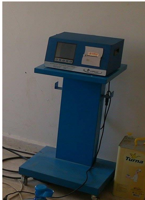
Şekil 5.6. Egzoz gazı analiz cihazı
