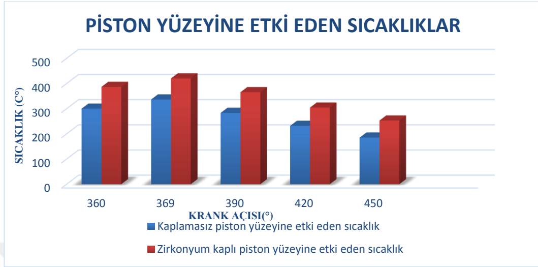
Şekil 41. Piston yüzeylerinde oluşan sıcaklıkların karşılaştırılması.
