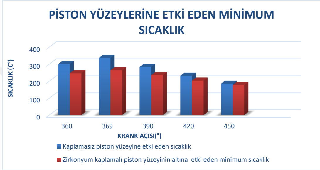
Şekil 43. Piston yüzeylerinde oluşan minimum sıcaklıklar.
