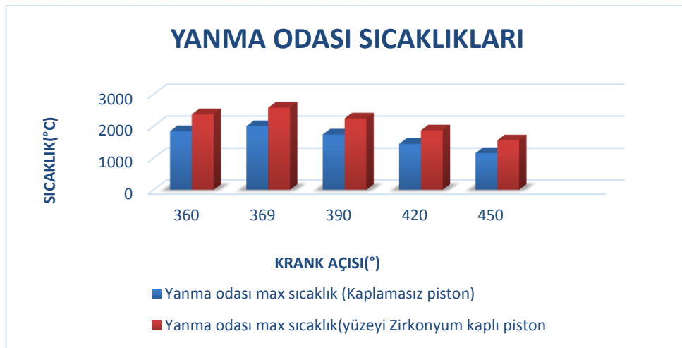
Şekil 40. Kaplamalı ve kaplamasız pistonların yanma odalarındaki sıcaklık grafiği.
