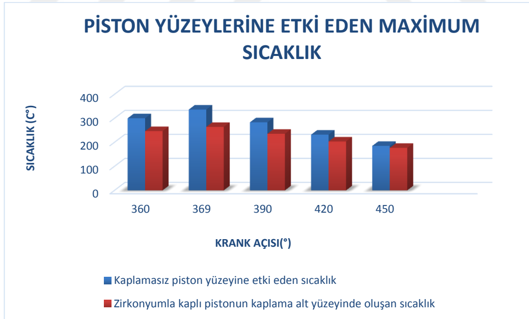
Şekil 42. Pistonların yüzeylerinde oluşan maximum sıcaklık dağılımı.
