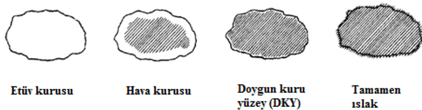
Şekil 3.7. Agregaların nem durumu (Alexander ve Mindess, 2010)
