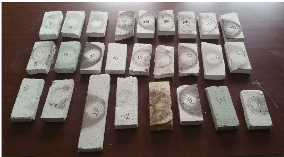
Şekil 10.30. Perlit esaslı yalıtım numunelerinin 5'er dakikalık yanma testi sonrası görünümleri.
