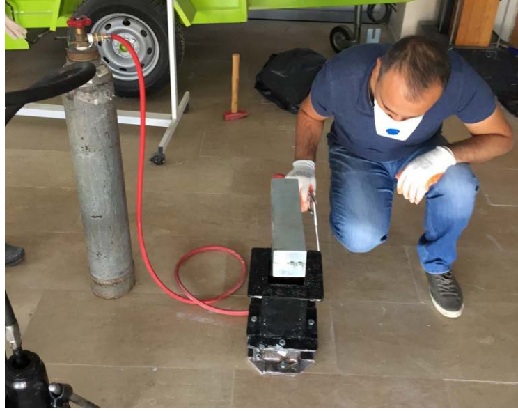
Şekil 7.16. CO 2 gazı ile sertleştirme
