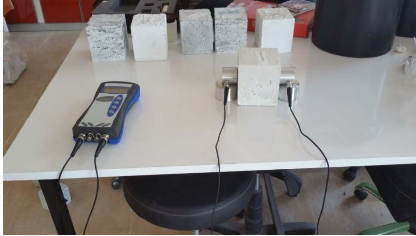
Şekil 6.15. Ultrasonik ses geçiş hızı tayini
