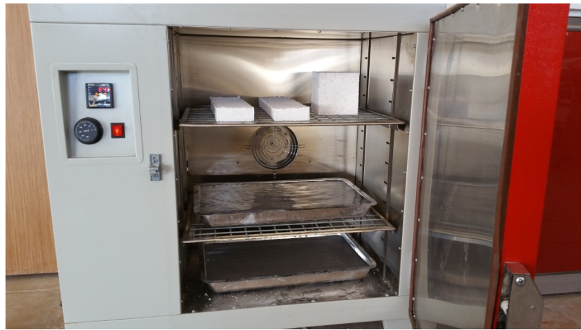
Şekil 7.20. Numunelerin etüvde kurutulması ve kürlenmesi
