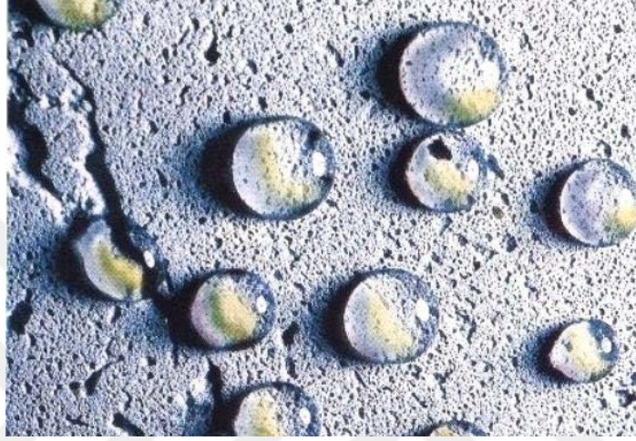
Şekil 7.7. Silikon sıvısının malzemede su engelleyici özelliği
