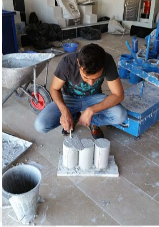
Şekil 6.9. Numunelerin kalıplara doldurulması
