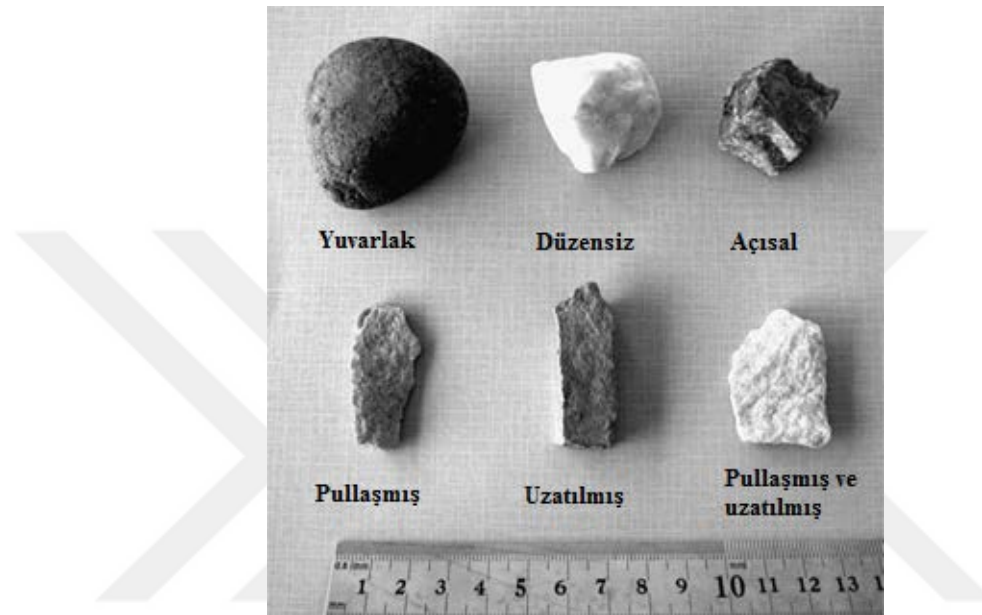
Şekil 3.8. Parçacık şekillerinin gösterimleri (Alexander ve Mindess, 2010)
