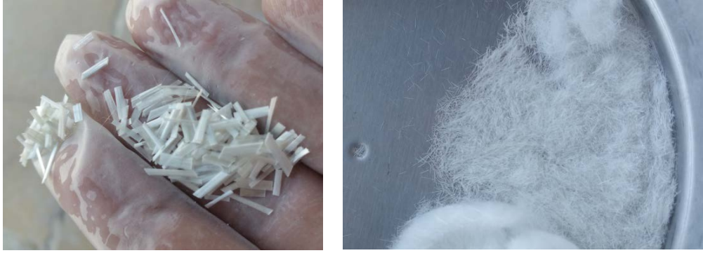
Şekil 7.12. Fiberlerin eleklerle ayrıştırılması; soldaki fiberlerin ilk bütün hali, sağdaki eleklerle ayrışmış hali
