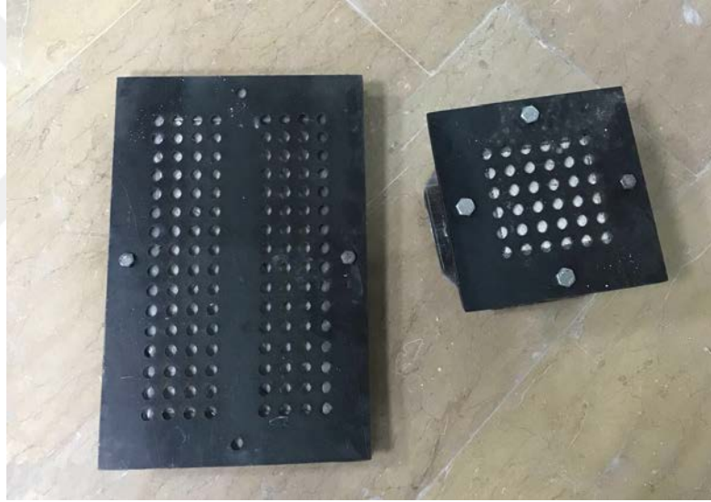
Şekil 7.17. Kalıpların delikli kapakla kapatılması
