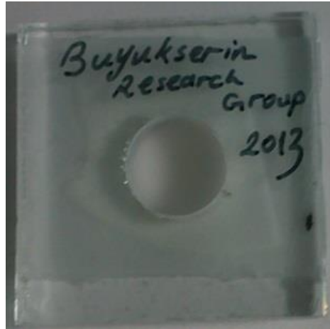
Şekil 3.21. Substrat ile ilgili ön çalışma sırasında hazırlanan 0,8 cm çaplı, 0,4 cm derinlikte 0,2 cm 3 hacimdeki bir bölgede fosforik asitte büyütülen AAO membranın aktif alan görüntüsü.
