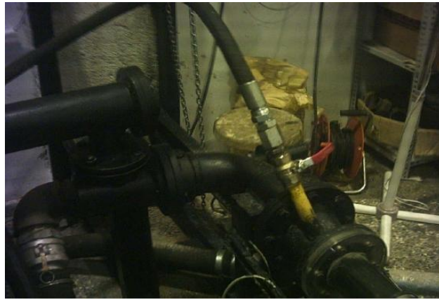
Şekil 3.13 : Sıvı ile Gazın Karıştığı Test Bölümünün Giriş Kısmı
