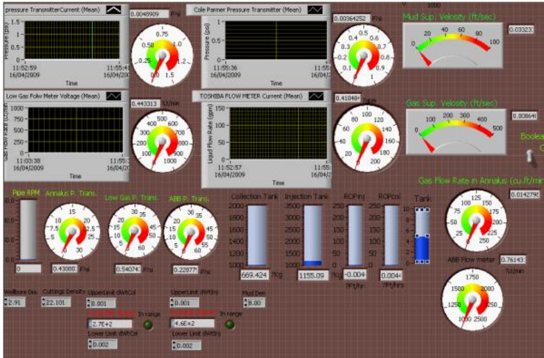
Şekil 3.15 : Veri Toplama Sistemi Geliştirilen Uygulamaya Ait Kontrol Paneli
