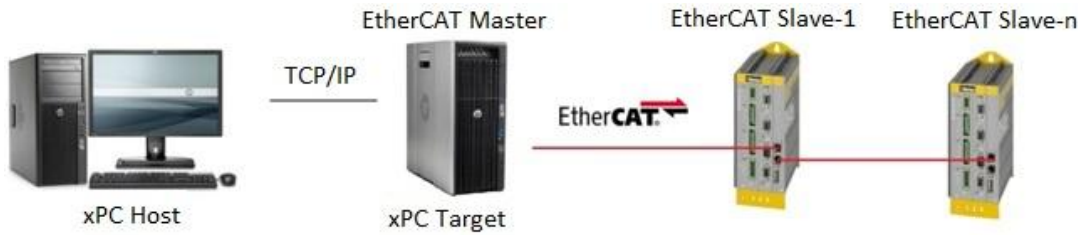
Şekil 39. EtherCAT merkez-uydu bağlantısı
