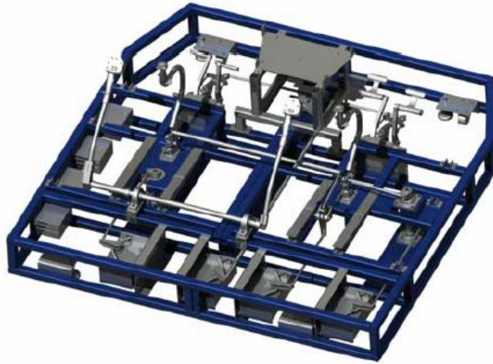
Şekil 14. Dört kanallı, tork motorlu KYS [19]
