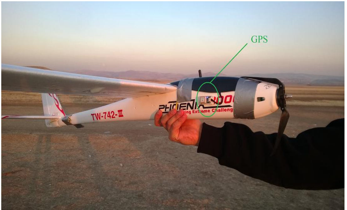
Şekil 4.4: Uçağın üzerinde donanım yerleştirilmiş hali (sol taraf)
