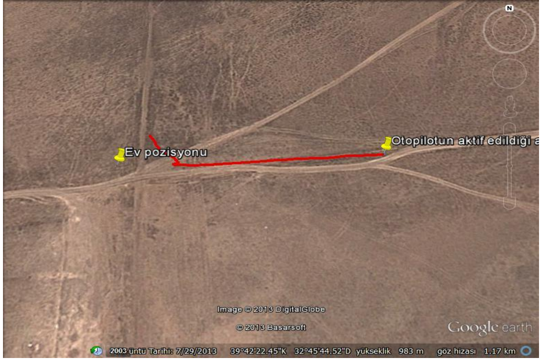
Şekil 4.19: Yeniden otopilot moduna geçildiği andan itibaren elde edilen uçuş rotası Şekil 4.17 ve Şekil 4.19’da belirtilen ev pozisyonu, yer kontrol istasyonunun bulunduğu nokta olarak düşünülebilir. Aynı uçuşta yer kontrol istasyonunun yer değiştirme hareketinin gösterildiği harita Şekil 4.20’de verilmiştir. 37.51 metre boyunca yer kontrol istasyonu hareket ettirilmiştir.
