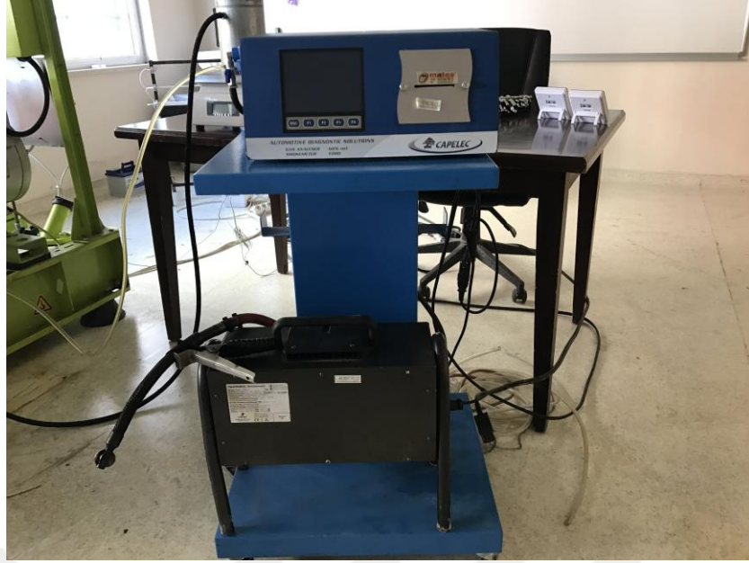
Şekil 3.4. Egzoz emisyon ve duman ölçüm cihazı
