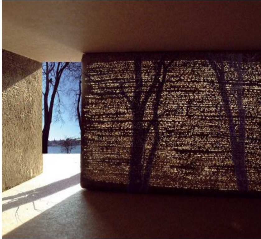
Resim 28: Litracon -Işık Geçiren Beton
