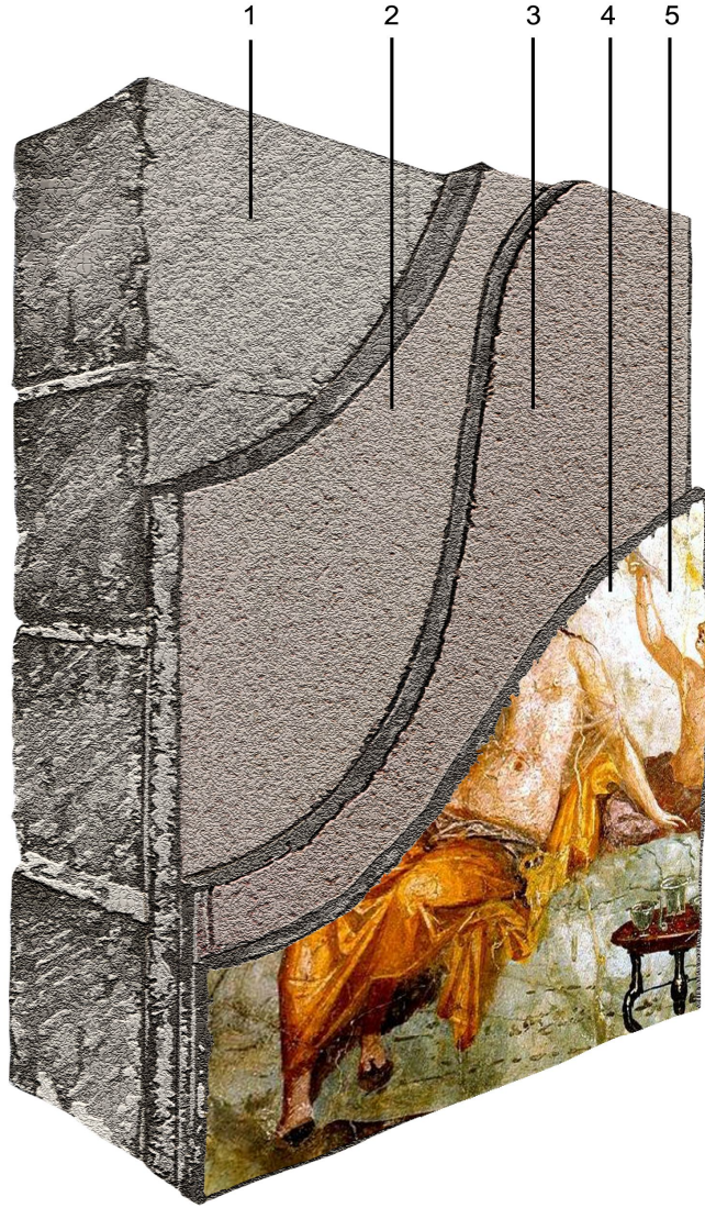
Resim 26: Yaş Fresko Tekniğini Oluşturan Katmanların Kesiti
