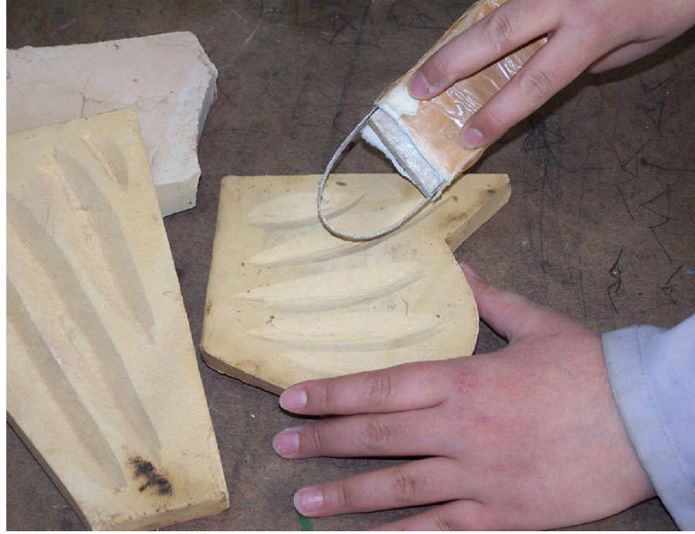
Resim 34: Seramik Parçalarının Arka Kısımlarına Oluk Açılması
