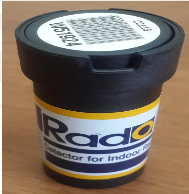
Şekil 3.3. CR-39 Pasif nükleer iz dedektörünü içeren difüzyon kabı
