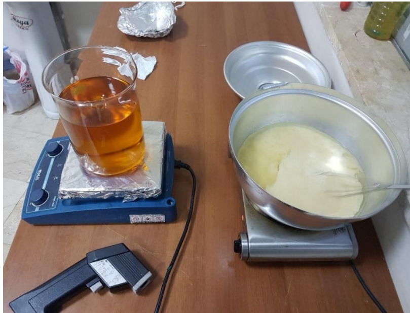
Şekil 5.7. Hint yağı biyodizelinin yıkama işlemi
