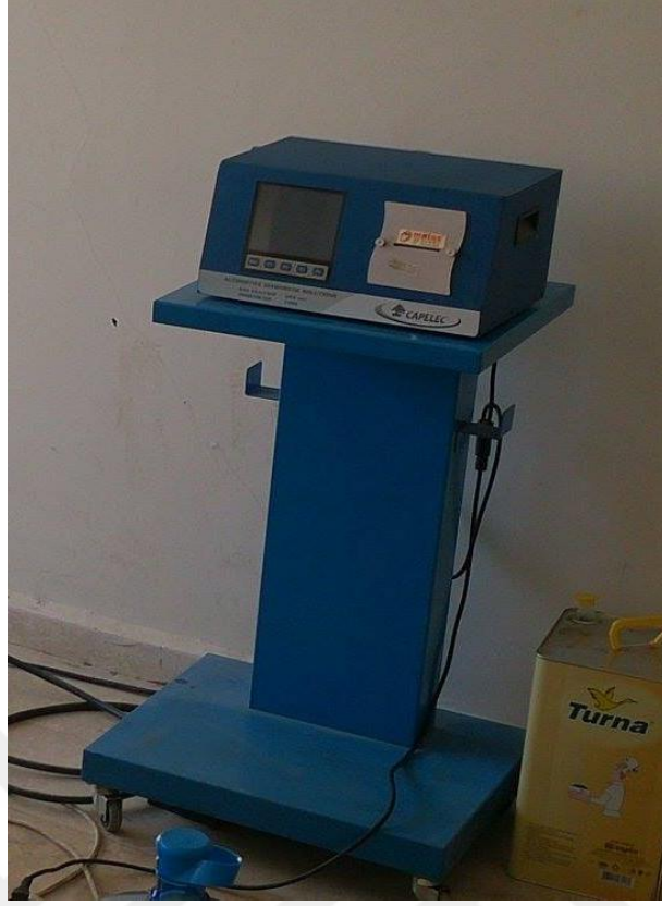
Şekil 5.4. Egzoz Gazı Analiz Cihazı
