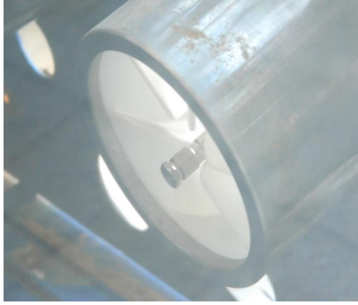
Şekil 4.19. Türbülator yuvası ve lülenin türbülator içerisindeki konumu
