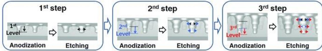
Şekil 2. 3: Kalıp olarak, sıralanmış 2D \text{Fe}_2\text{O}_3 parçacıklar kullanılarak, iyi düzenlenmiş anodik porlu alüminanın üretilmesinin şematik gösterimi: 1) 2D sıralanmış \text{Fe}_2\text{O}_3 parçacıklar üzerine Al katman kaplanması, 2) \text{Fe}_2\text{O}_3 /Si 'dan Al tabakanın ayrılması, 3) \text{Fe}_2\text{O}_3 parçacıkların ayrılması, 4) Alüminyumun anodizasyonu a) Si üzerinde 2D sıralanmış \text{Fe}_2\text{O}_3 parçacıklar, b) Püskürtme ile kaplanmış Al tabakası, c) düzenli sıralanmış konkavlardan oluşan Al tabakası, d) Porlu anodik alümina [11].
