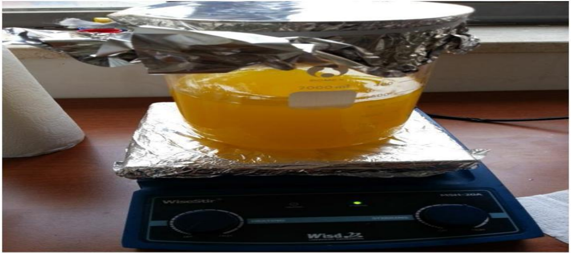
Şekil 7.8. katalizor+metil alkol katılarak ısıtılan yağ
