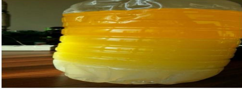
Şekil 7.11. Yıkanmış biyodizeldeki faz ayrımı
