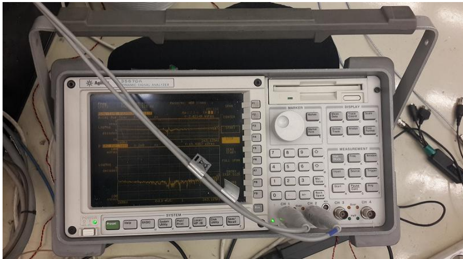
Şekil 2.4. Sistem tanılama işlemi için kullanılan sinyal jeneratörü
