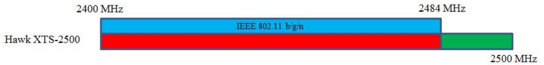
Şekil 1.18. IEEE 802.11 Protokolü frekans aralığı ile Hawk XTS-2500 detektörünün uyarı sinyali frekans aralığının çakışması
