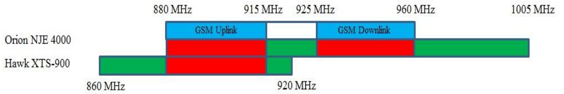
Şekil 1.17. GSM frekans aralığı ile Orion NJE 4000 ve Hawk XTS-900 detektörleri uyarı sinyalleri frekans aralıklarının çakışması
