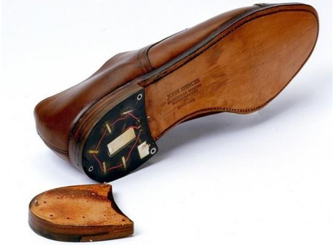
Şekil 1.4. Ayakkabı içerisine gizlenmiş bir verici
