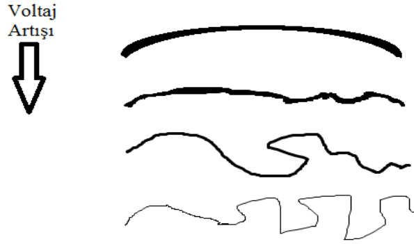
Şekil 2.8. Gerilim artışının jet üzerindeki etkisi
