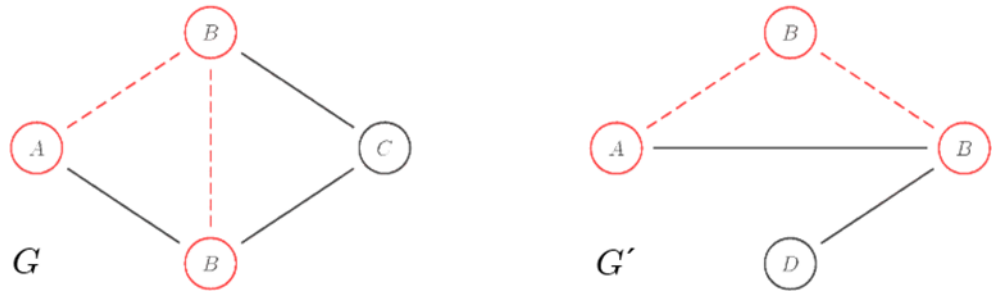
Şekil 3.3. Çizge temsilleri üzerinde basit bir örüntü tanıma örneği. G ve G' çizgelerinin benzerlikleri kırmızı renk ile gösterilmiştir.
