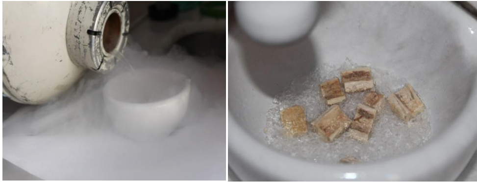
Şekil-24 Femur kemiklerinden bazıları sıvı azot kullanılarak toz haline getirilmiştir
