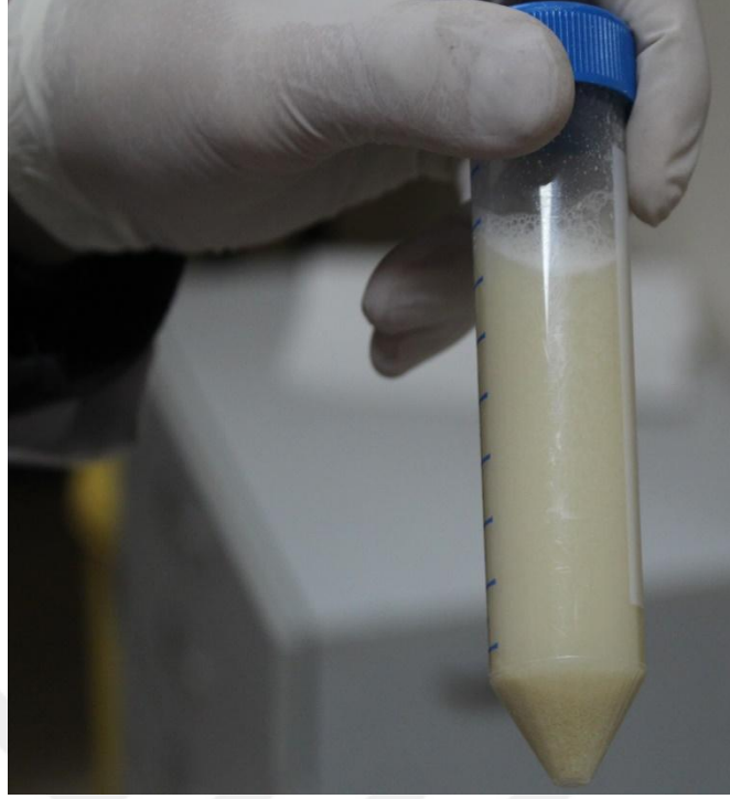
Şekil-27 Toz hale getirilmiş olan kemik örneklerine EDTA solüsyonu eklenmiştir.
