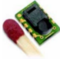
Şekil 2.4: Küçülen boyutların bir örneği: ısı-nem sensörü
