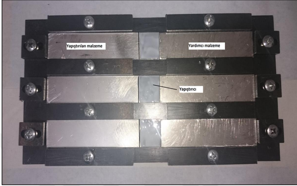
Şekil 3.11. Yardımcı malzemelerin kalıba yerleştirilmesi
