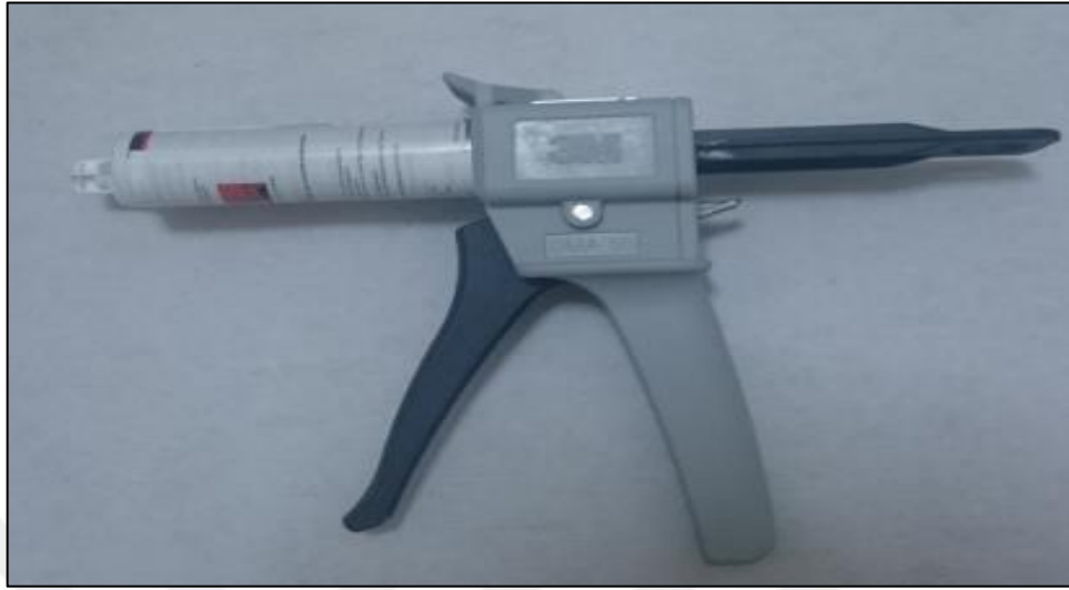
Şekil 3.6. DP 460 epoksi yapıştırıcı ve uygulama aparatı
