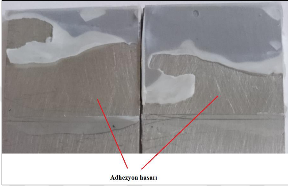
Şekil 4.11. Katkısız numune hasar yüzeyi
