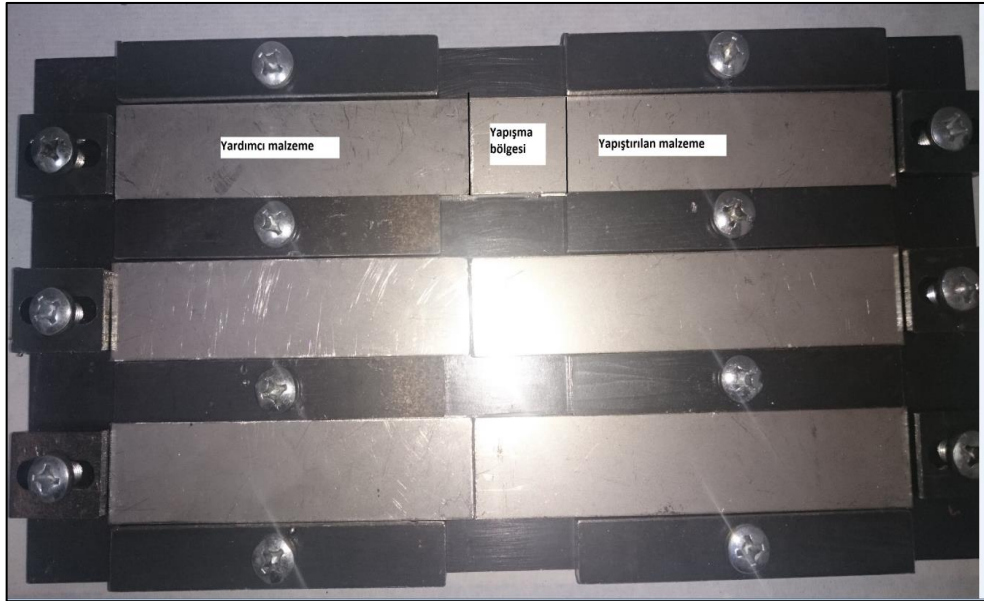
Şekil 3.12. Yapıştırılan malzemelerin ikincisinin kalıba yerleştirilmesi
