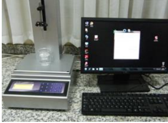
Şekil 3.2. Holmarck sol-jel daldırma cihazı
