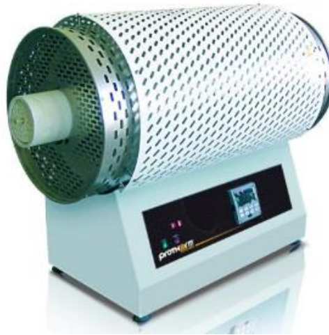
Şekil 3.1. 0-1200 °C ayarlanabilir Protherm PTF 12/75/800 tüp fırın
