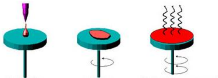
Şekil 2.13. Sol-jel döndürme yöntemiyle kaplama aşamaları
