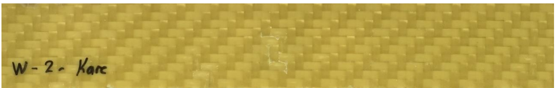
Şekil 3.35. [\pm 45]_8 oryantasyon açılı, 2. – 3. tabakaları arasında kare delaminasyon bulunan numune
