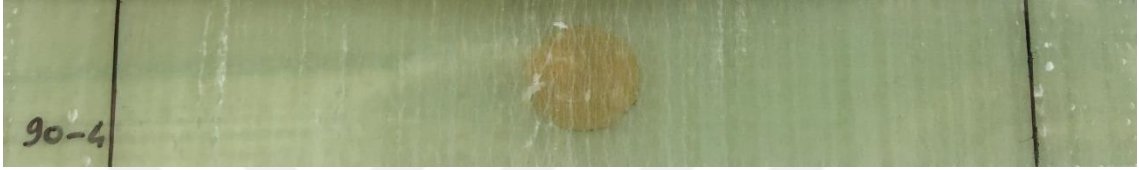
Şekil 3.26. [90]_8 oryantasyon açılı, 4. – 5. tabakaları arasında dairesel delaminasyon bulunan numune
