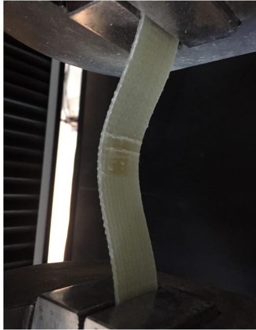
Şekil 3.44. Cam – epoksi numunesinin ankastre mesnet durumunda 118 x 25 boyutu
