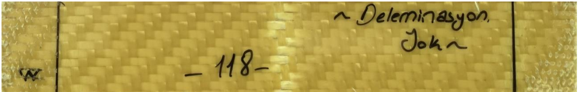
Şekil 3.34. [\pm 45]_8 oryantasyon açılı delaminasyonsuz numune
