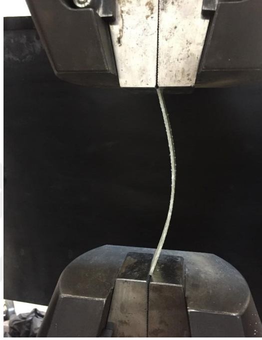
Şekil 3.43. Cam – epoksi numunesinin sabit – sabit mesnet durumunda 150 x 25 boyutu
