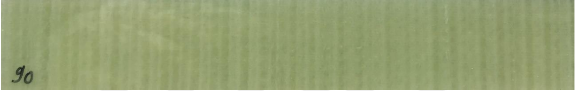
Şekil 3.20. [90]_8 oryantasyon açılı delaminasyonsuz numune
