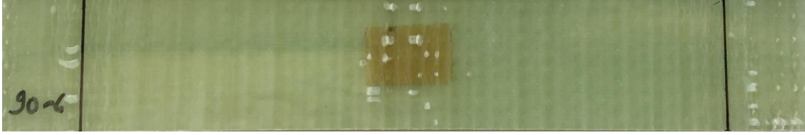
Şekil 3.25. [90]_8 oryantasyon açılı, 4. – 5. tabakaları arasında dikdörtgen delaminasyon bulunan numune
