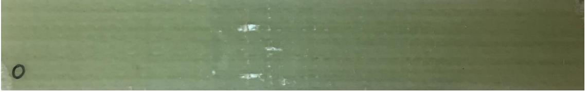
Şekil 3.13. [0]_8 oryantasyon açılı delaminasyonsuz numune
