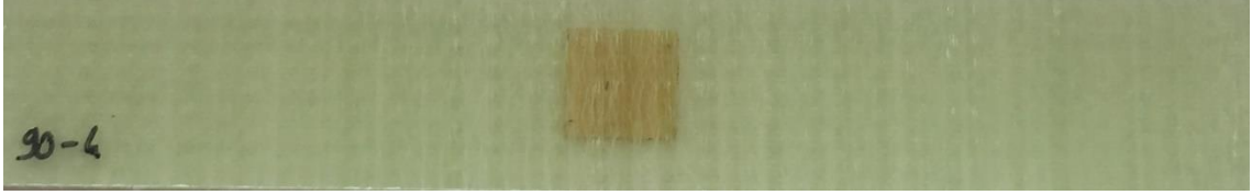
Şekil 3.24. [90]_8 oryantasyon açılı, 4. – 5. tabakaları arasında kare delaminasyon bulunan numune
