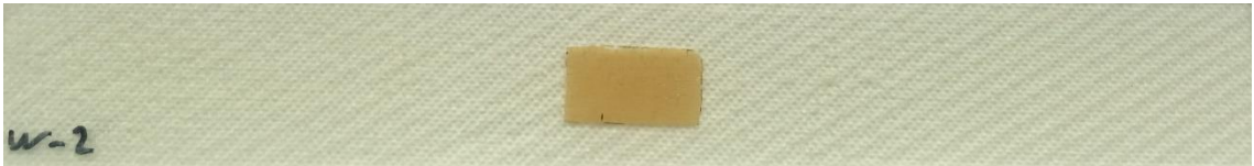
Şekil 3.29. [\pm 45]_8 oryantasyon açılı, 2. ve 3. tabakaları arasında dikdörtgen delaminasyon bulunan numune
