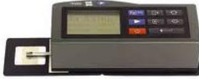
Şekil 3.6. Yüzey pürüzlülük ölçüm cihazı
