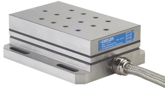
Şekil 3.3. Kistler 9257B piezo-elektrik dinamometre
