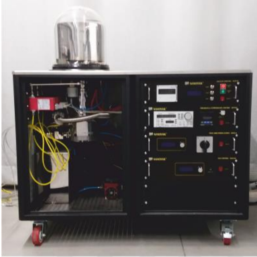
Şekil 3.6: TOBB ETU Nanokompozit ve Seramik Laboratuvarı bünyesinde vakum fırın
