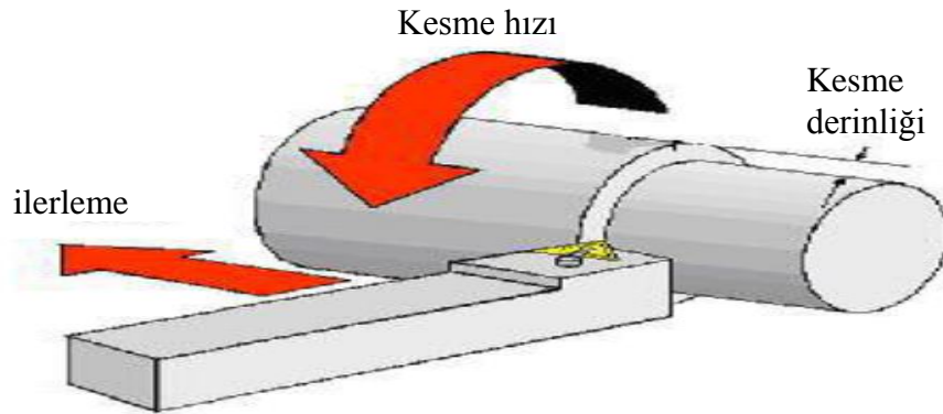
Şekil 3.2. Kesme parametrelerinin tornalama işleminde gösterimi (Bingül, 2014)
