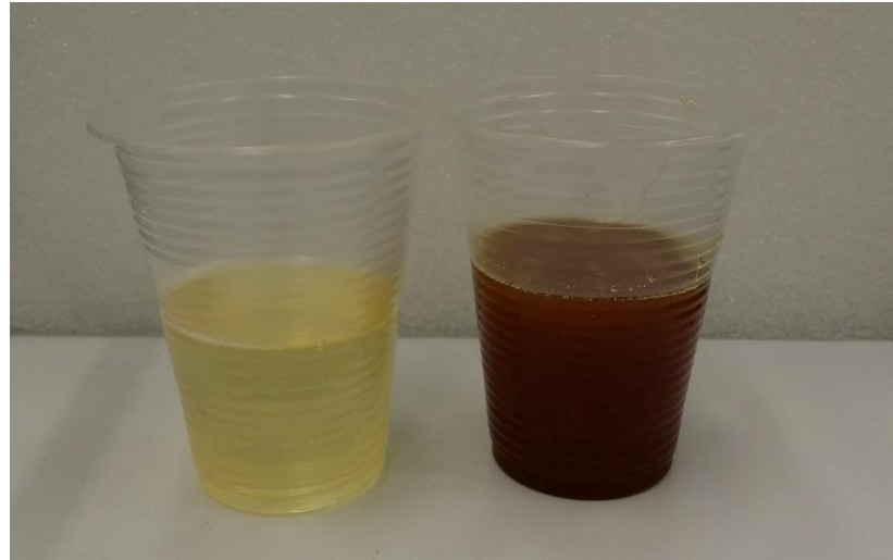
Şekil 2.3. Poliüretan için temin edilen sıvı haldeki poliöl ( solda ) ve poliizosiyanat ( sağda ).
