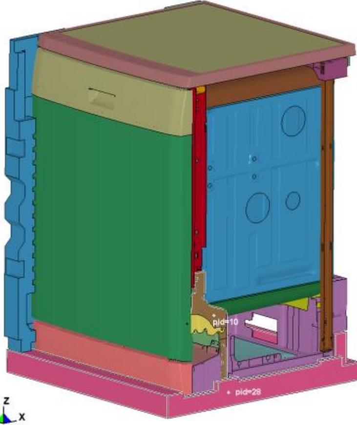
Şekil 5.4. Bulaşık makinesi mekanik yapısı ve ambalaj modülü: kademeli ayak (pid=10) ve alt köpük (pid=28)
