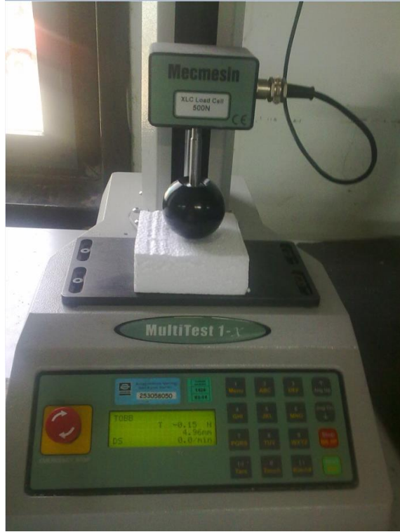
Şekil 3.7. EPS köpüğü basma testi düzeneği.
