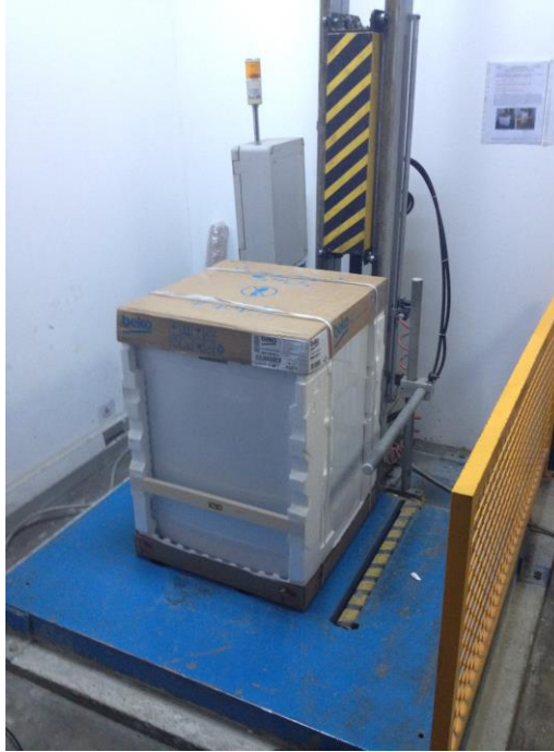
Şekil 4.1. Düşürme test düzeneği.
