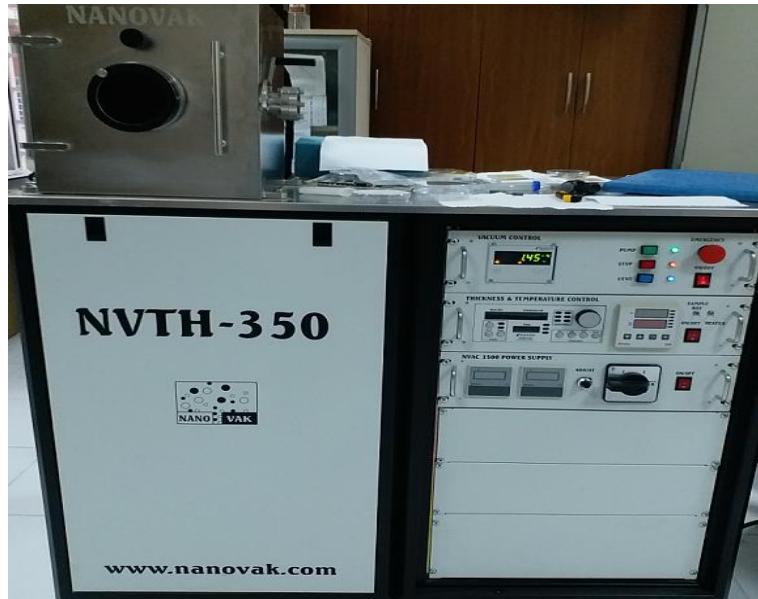
Şekil 2.8. Termal buharlaştırma sistemi (Batman Üniversitesi)
