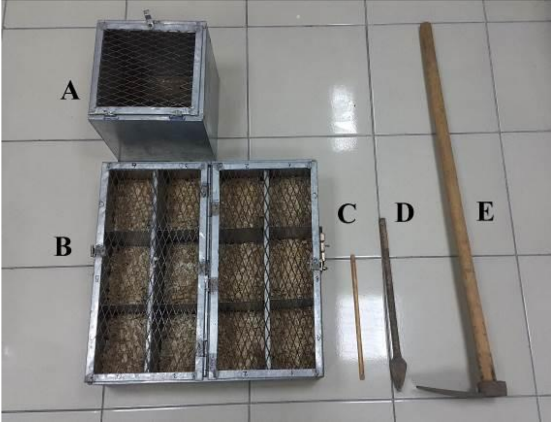
Őekil 3.2. Arazi çalışmalarında kullanılan araç ve gereç (A. Besleme kafesi, B. Taşıma kafesi, C. Yön belirleme çubuđu, D. Mızrak ve E. Çapa)
