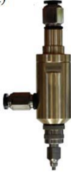
Şekil 3.3 : Ortak eksenli elektro-eğirme iğnesi (A) Yandan görünüm (B) Alttan görünüm.
