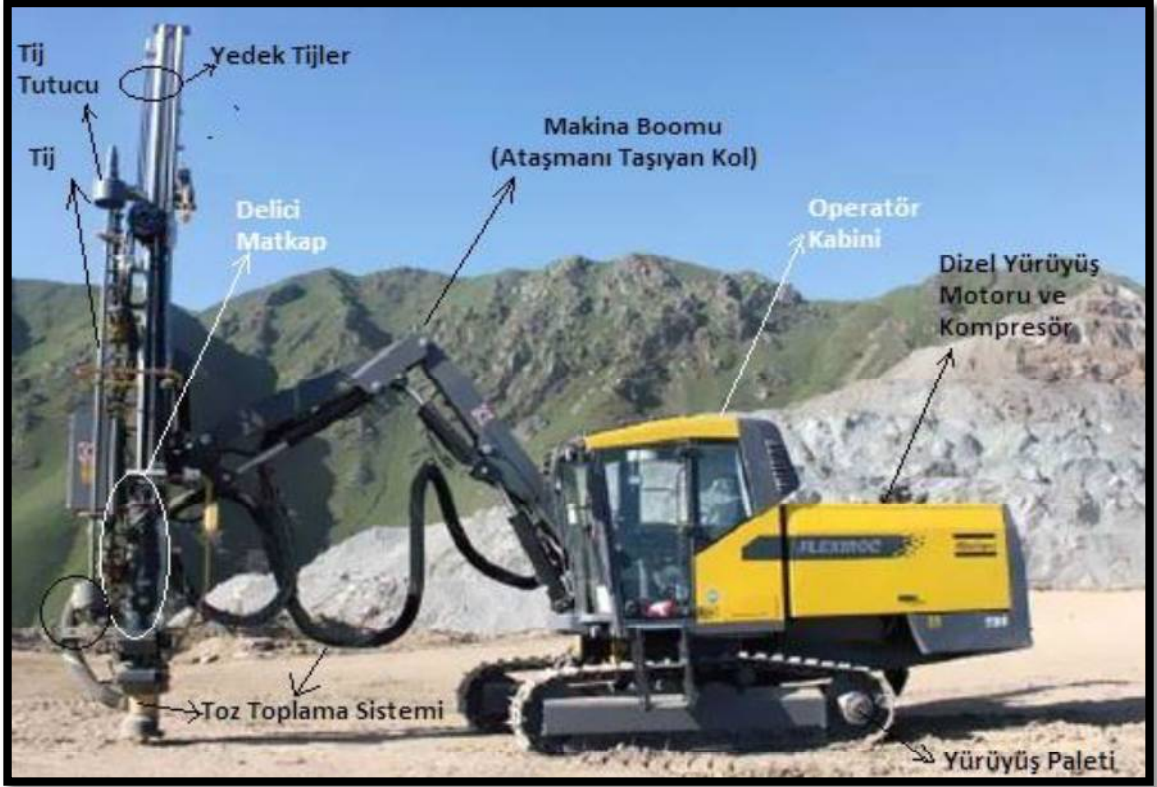
Şekil 4.7. İşletmede kullanılan tipik bir delici makine
