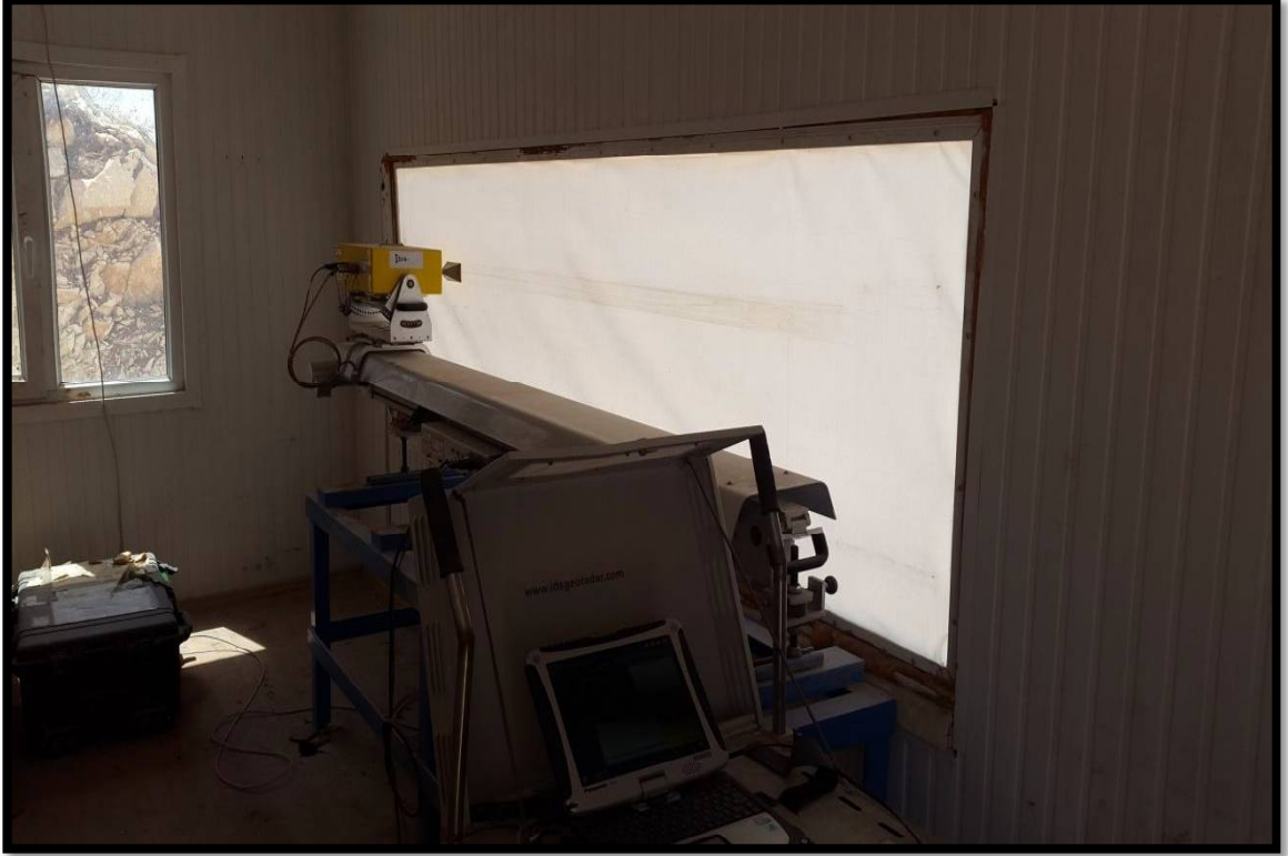
Şekil 4.9. IBIS şev izleme istasyonu
