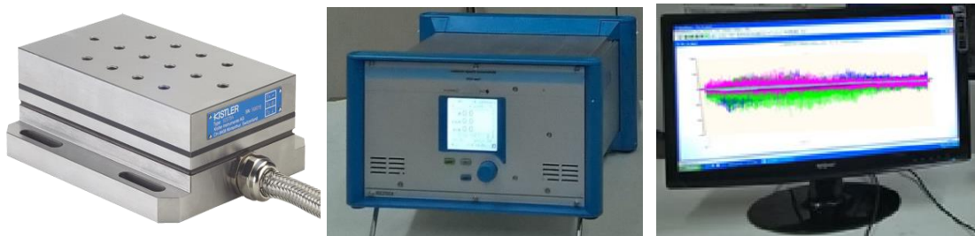
Şekil 3.8. Kesme kuvveti ölçüm düzeneği
