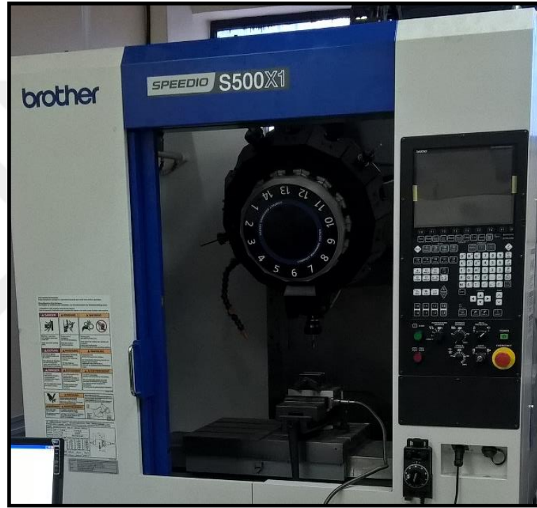
Şekil 3.6. Deneylerde kullanılan CNC dik işleme merkezi
