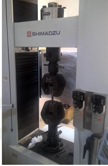
Şekil 3.4. Shimadzu AG-X çekme testi cihazı
