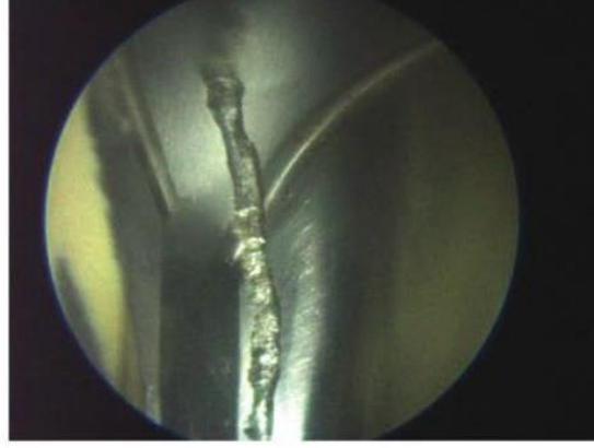
Şekil 1.10 : Kanatlar arası girdap kavitasyonu [16].
