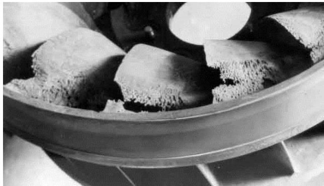
Şekil 1.8 : Gezer baloncuk kavitasyonu sebebiyle aşınmış Francis çarkı [27].
