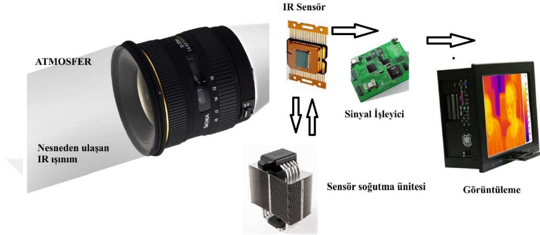
Şekil 3.3 : Bir termal görüntüleme sisteminde yer alan alt bölümler.
