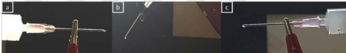
Resim 2.3: Üçlü elektro eğime sistemindeki şırıngalarda gözlemlenen Taylor konileri (a) PCL/CTGF solüsyonu içeren şırıngadaki Taylor konisi, (b) PCL/TGF- \beta 3 solüsyonu içeren şırıngadaki Taylor konisi, (c) PCL/nHA süspansiyonu içeren şırıngadaki Taylor konisi.
