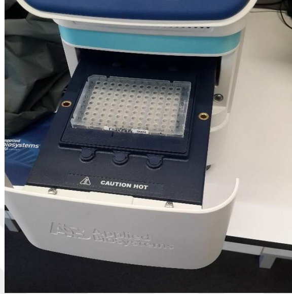
Şekil 2.13: 96 kuyucuklu real-time PCR plakasının cihaz içine yerleştirilmesi.
