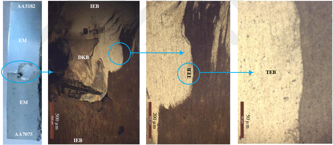
Şekil 5.24. FSW k218 numunesinin konik karıştırıcı uç ile birleştirilmesindeki makro ve mikroyapılar
