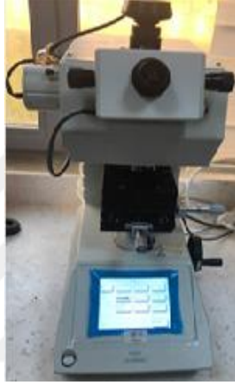
Şekil 4.14. Sertlik ölçüm cihazı
