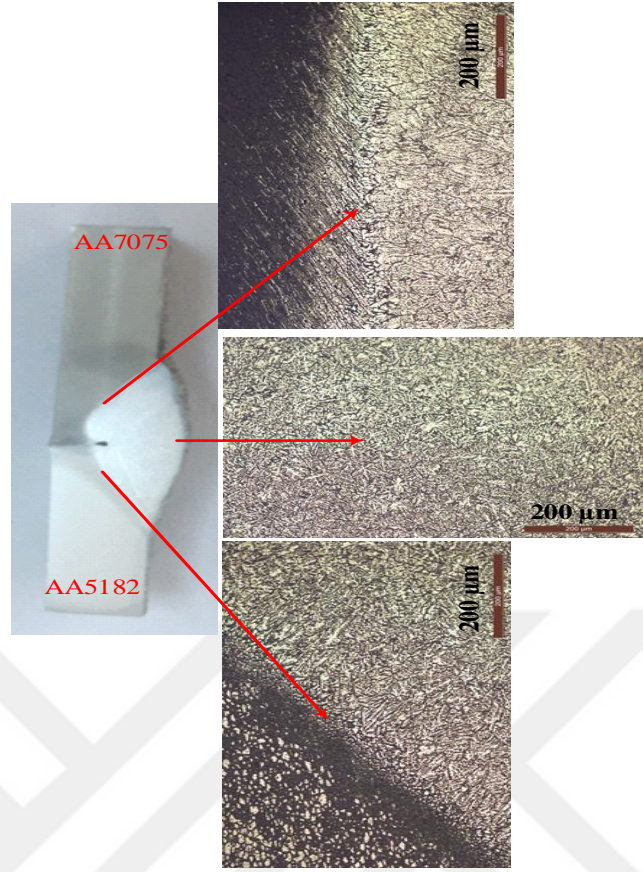
Şekil 5.12. Mv_{3815} numunesine ait makro ve mikroyapılar
