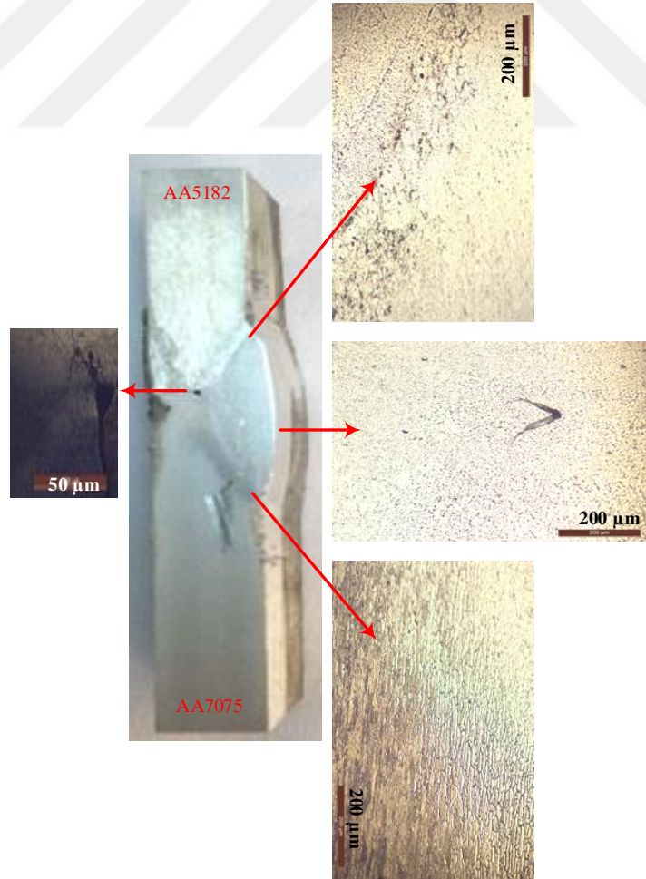
Şekil 5.4. Tv 1213 numunesine ait makro ve mikroyapılar
