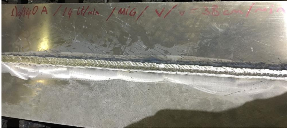
Şekil 4.4. MIG kaynağı yapılmış plaka (AA7075/5182)
