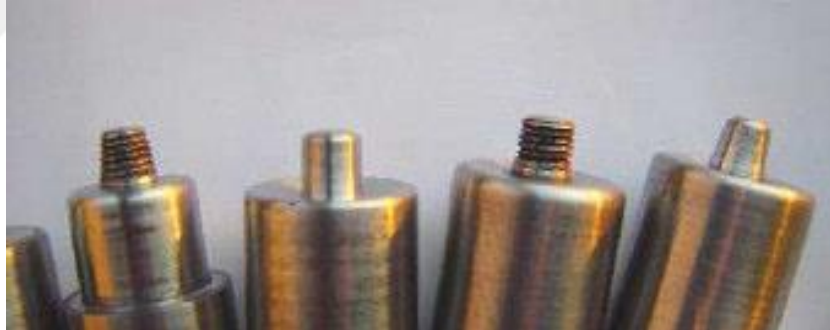
Şekil 3.13. Farklı geometrilere sahip karıştırıcı uçlar (Zhao ve ark., 2005)
