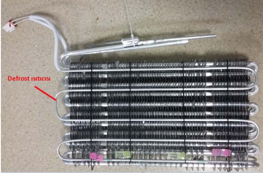
Şekil 2.8: Dondurucu kanatçıklı buharlaştırıcı ve defrost ısıtıcısı.
