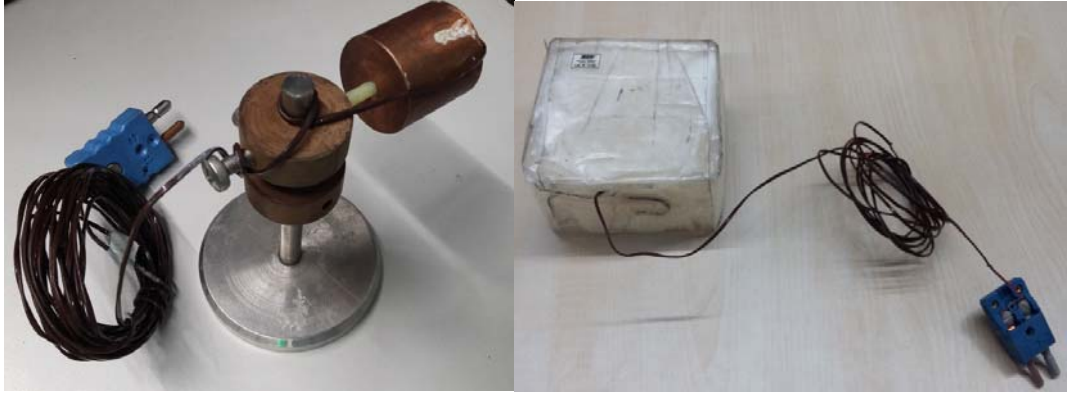
Şekil 2.4: 3 inç bakır blok ve dondurucu ölçüm paketi (M Paketi).
