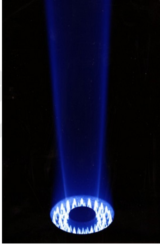
Şekil 4.15: Flame D test düzeneği fotoğrafı [22] .
