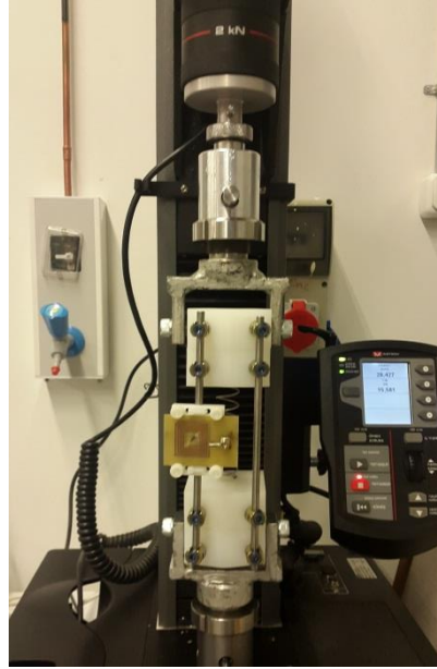
Şekil 2.31: Uzun segment modelde basma ve çekme deney düzeneği
