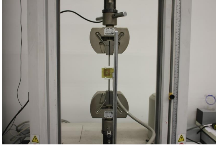
Şekil 2.44: Eksensel çekme test düzeneği
