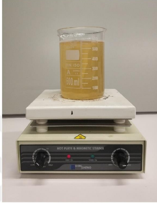
Resim 4.2 Manyetik karıştırıcı yardımıyla jelatin tozu/su karışımı hazırlama süreci.
