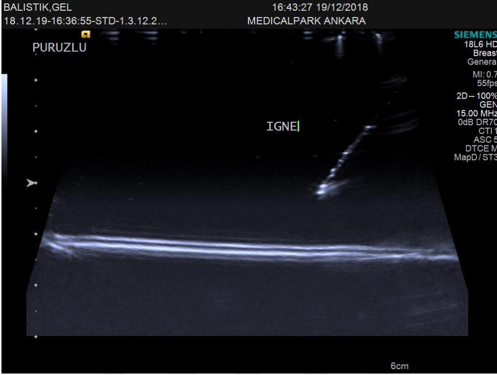
Resim 4.10 İçerisine iğne batırılmış fantom modelinin ultrason görüntüsü.
