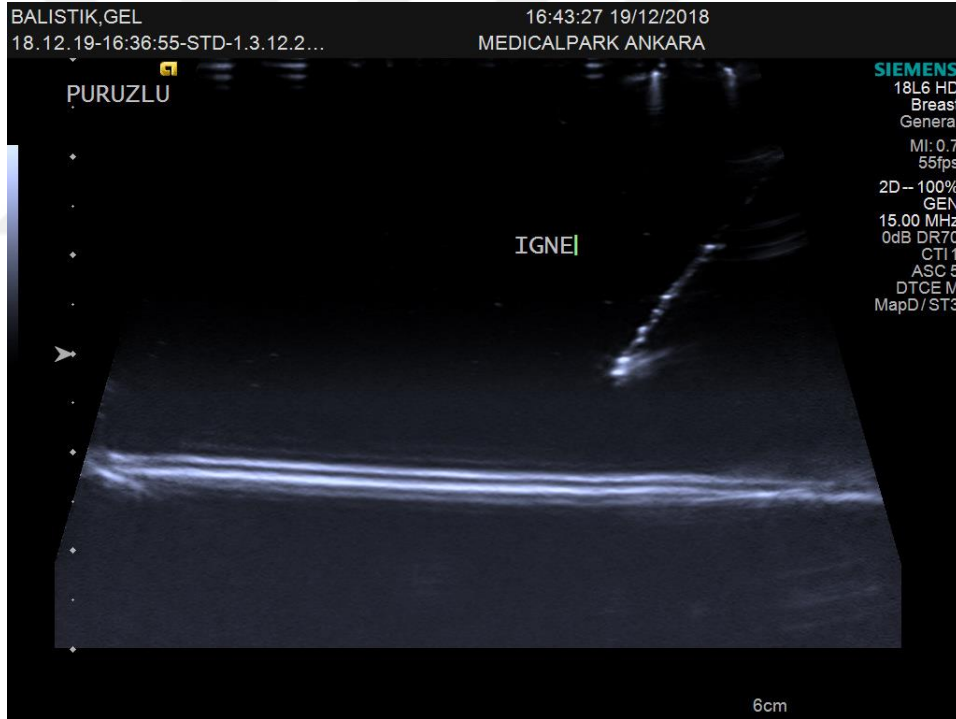
Resim 5.6 Eritilip tekrar kalıplanmış fantom modelinin ultrason görüntüsü.
