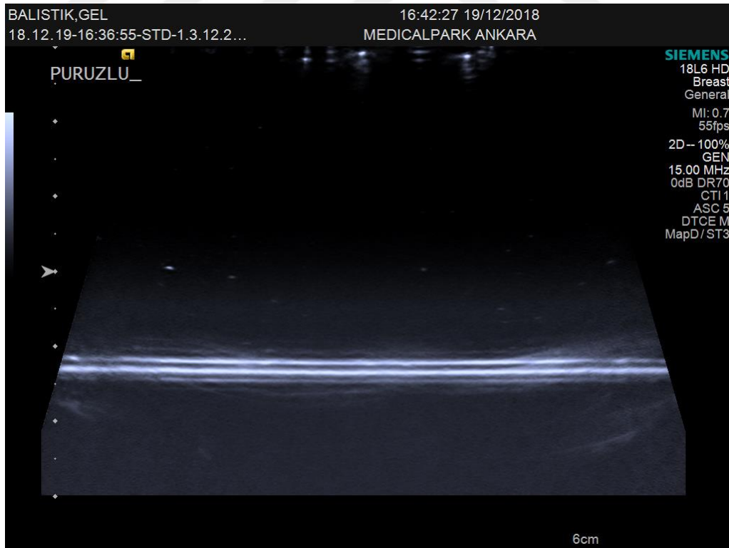
Resim 4.9 Tarçın yaprağı yağı eklenmemiş fantom modelinin üzerinde oluşan pürüzlü yapının ultrason görüntülerinde artefakta sebep olması.
